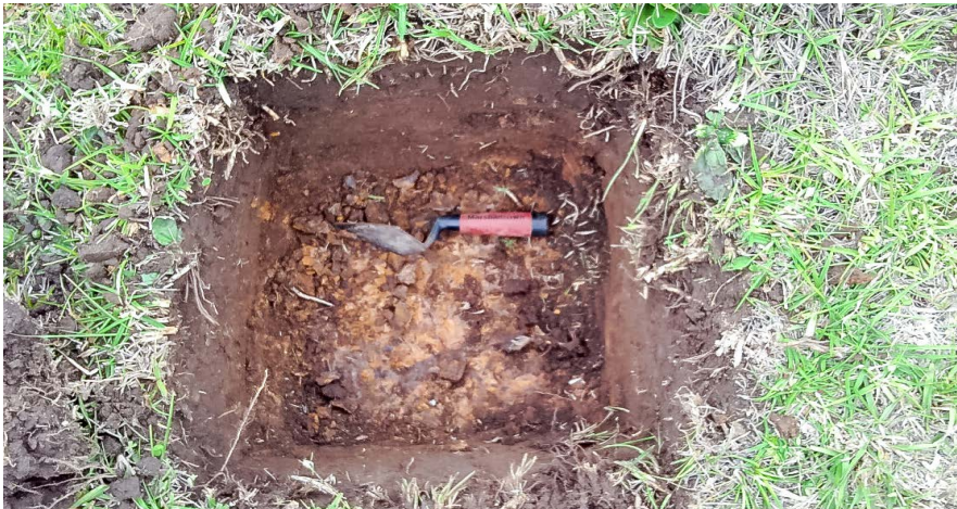
Figura 2.3. Pozo de sondeo
